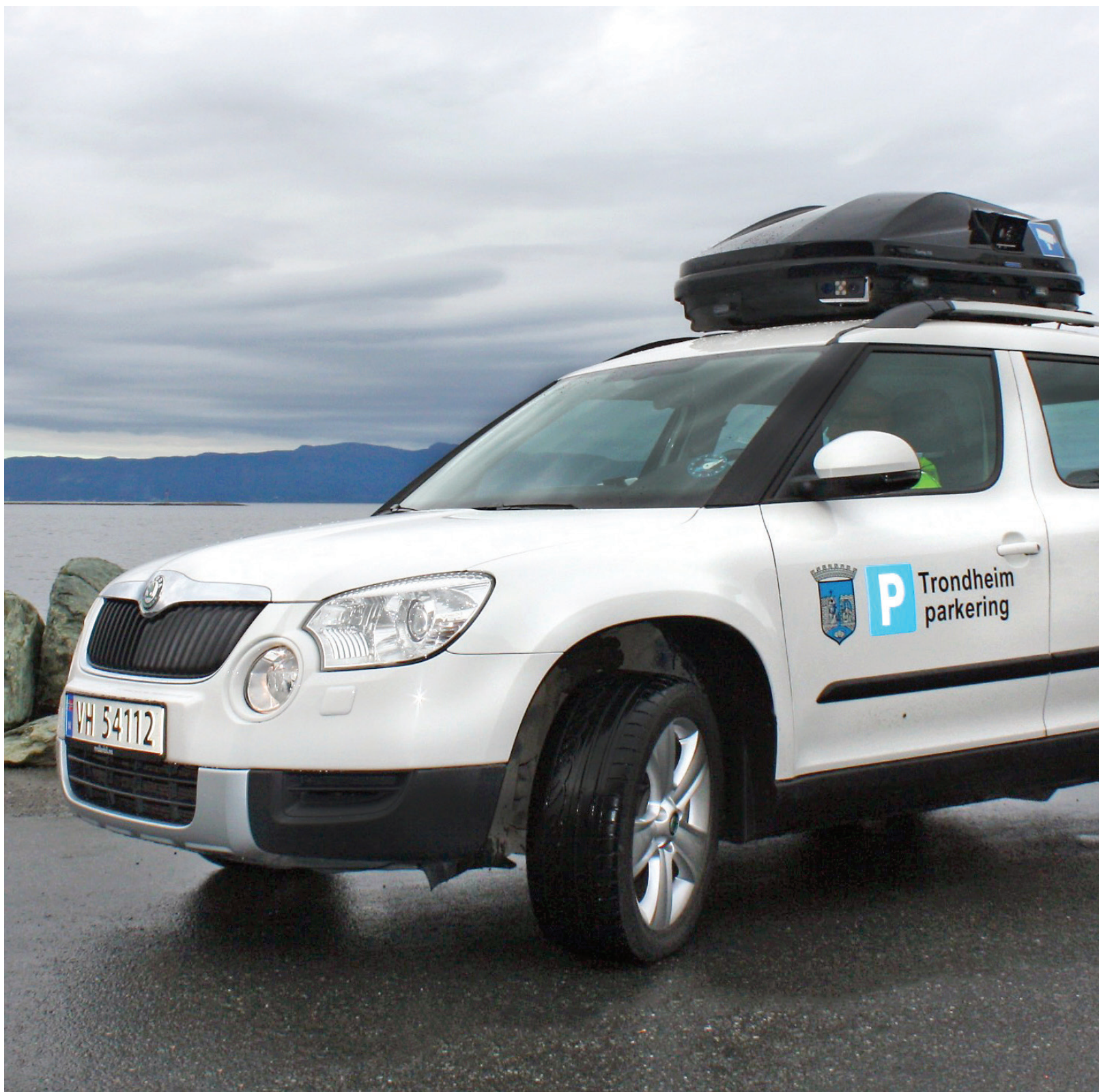
Сканиращ автомобил за контрол на паркирането в зоните за платено почасово паркиране в гр. Трондхайм, Норвегия. Източник: © Трондхайм паркинг
