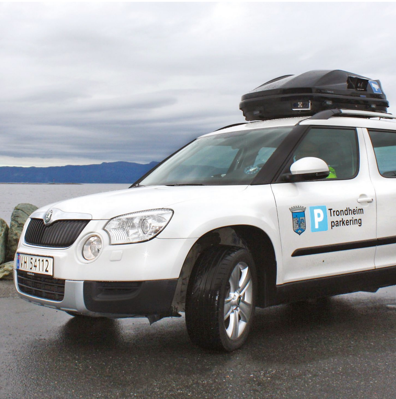
Controllo della sosta con scanner automatizzato. Fonte: © Trondheim parkering
