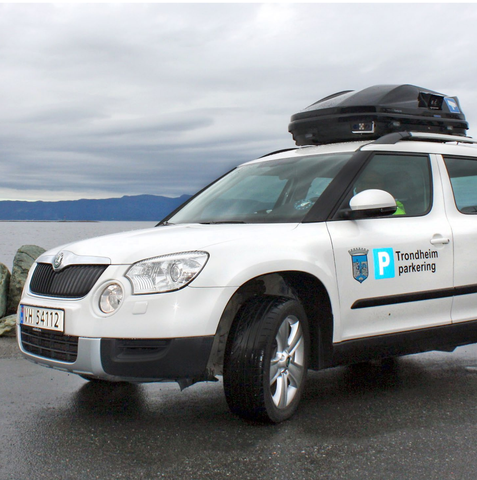
Coche con dispositivo de escaneo en Trondheim Source: © Trondheim parkering
