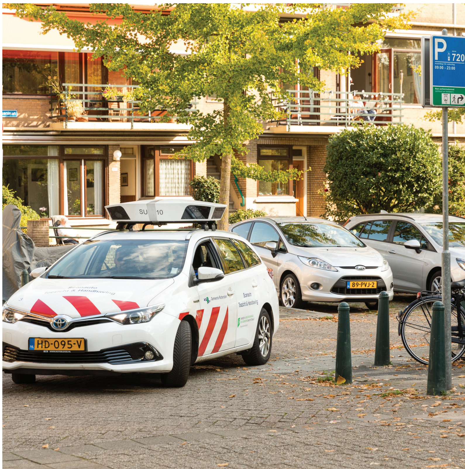
Automobil na kontrolu parkování čtením registračních značek v Rotterdamu © FGM / Harry Schiffer.
